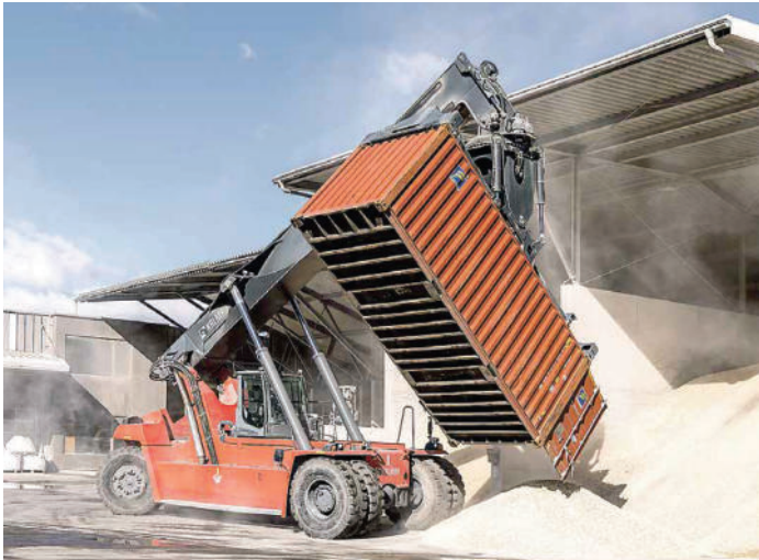
Bis zu 55 Grad kann der aufgenommene Container gekippt werden. Foto: Morgenstern
