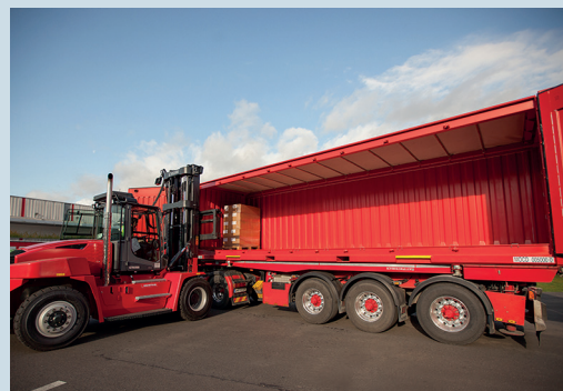
Be- und Entladung mit Stapler von der Seite Loading and unloading with forklift truck from the side
