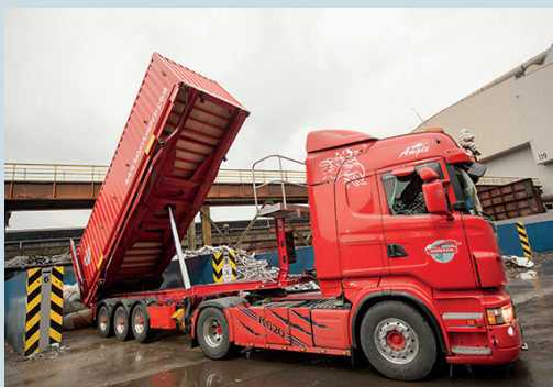
Entladung loser Ware durch Abkippen Discharging of bulky material by tipping
