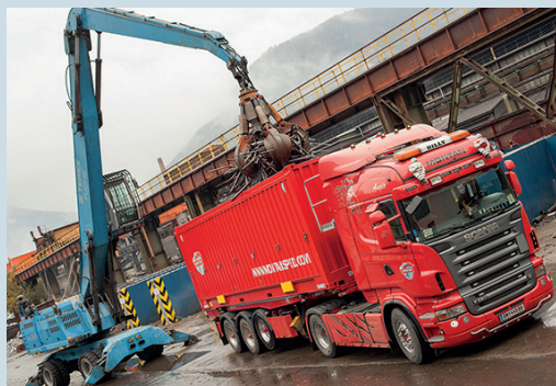
Beladung mit loser Ware von oben Loading with bulky material from the top
